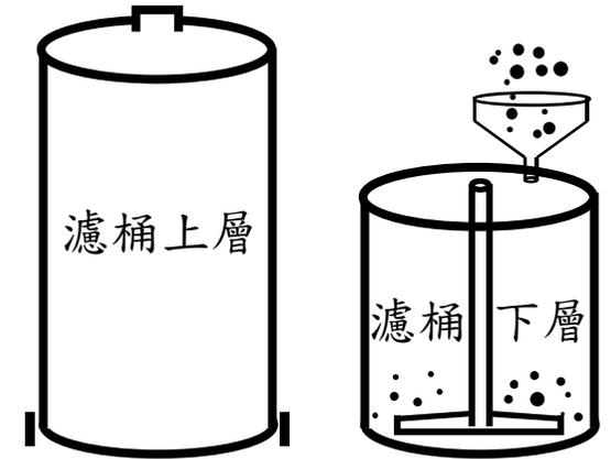
4. 濾材倒入完成，即可將上層與下層兩部份進行組立動作(上層底下的塑膠管與下層塑膠管上方，兩隻須對齊後插入)，接著再將螺絲裝上
