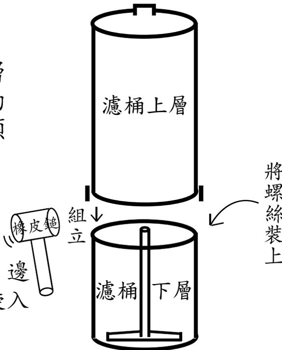
◎ 鎖螺絲過程中可持橡皮鐵鎚，邊鎖螺絲邊鎚束帶，以利螺絲旋入
