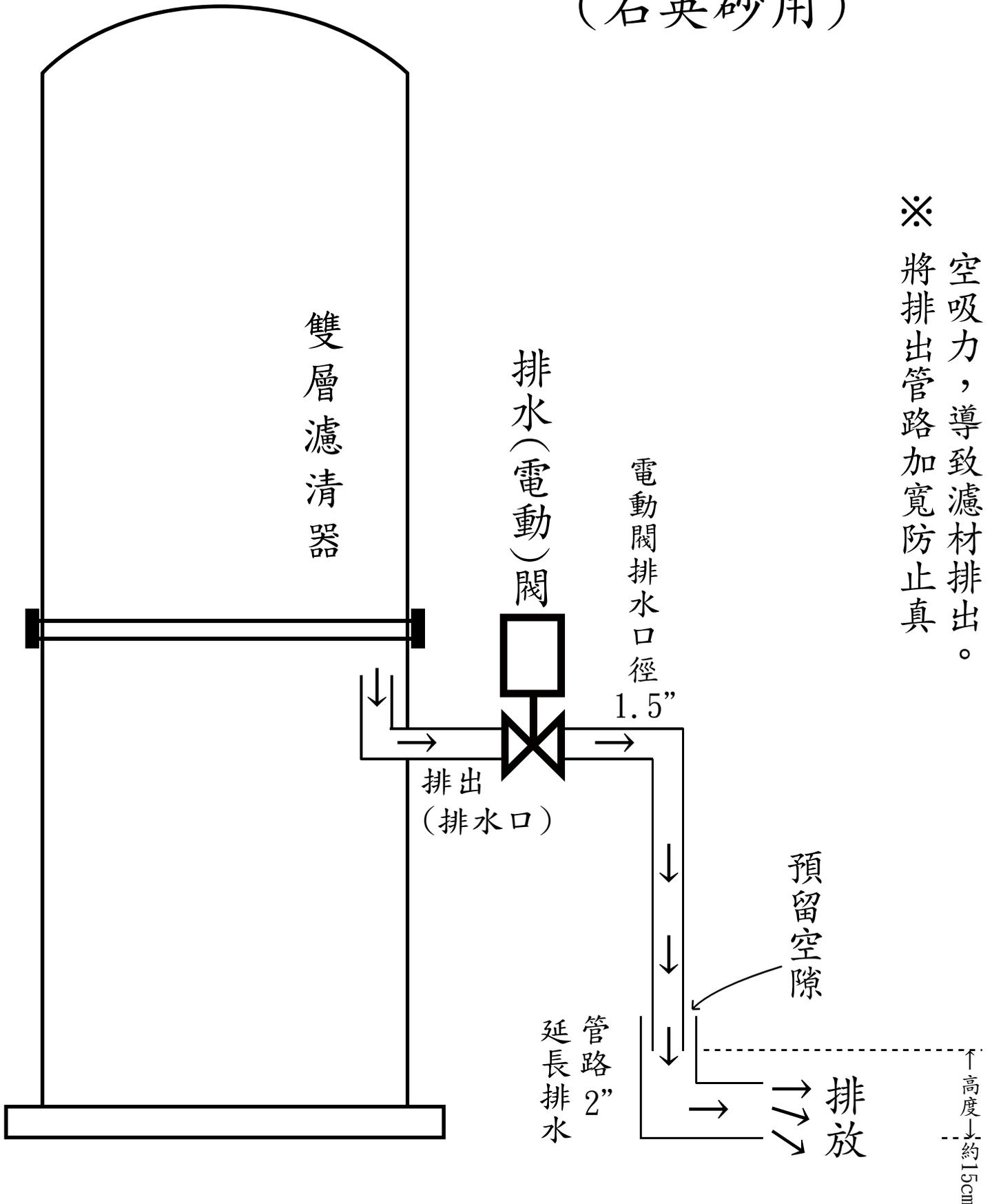
※ 將排出管路加寬防止真空吸力，導致濾材排出。
